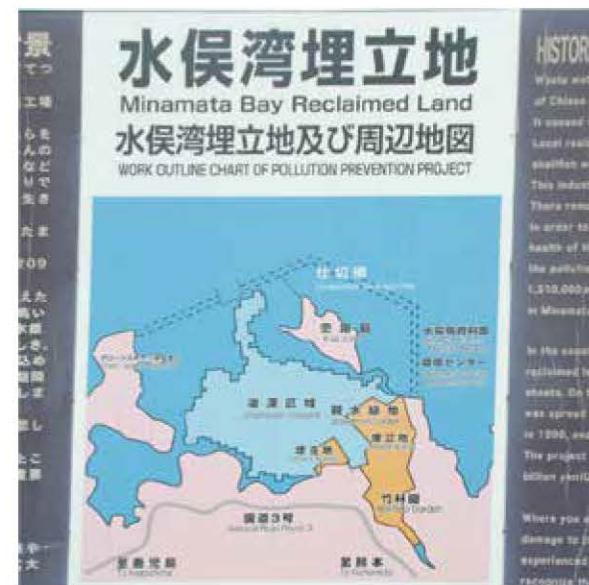
点線の範囲に仕切り網が設置された
