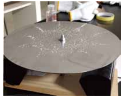
鉄板上に現れたクラドニ図形
