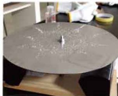
鉄板上に現れたクラドニ図形
